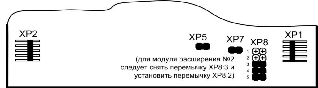
Рисунок 2. Расположение контактов и контактных колодок на печатной плате модуля расширения.
